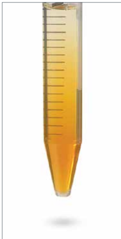
Nicht durchmischte, aufgetaute Probe. Die Proteine setzen sich unten im Reagenzglas ab; die Probe muss vor der Entnahme durchmischt werden.
