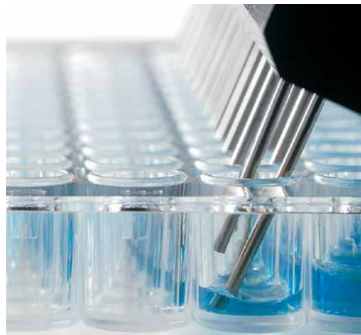
Richtige Positionierung der Nadeln des manuellen Waschgerätes für die Aspiration von Flüssigkeit
