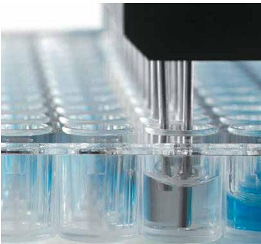
Richtige Positionierung der Nadeln des manuellen Waschgerätes zur Abgabe von Waschlösung
